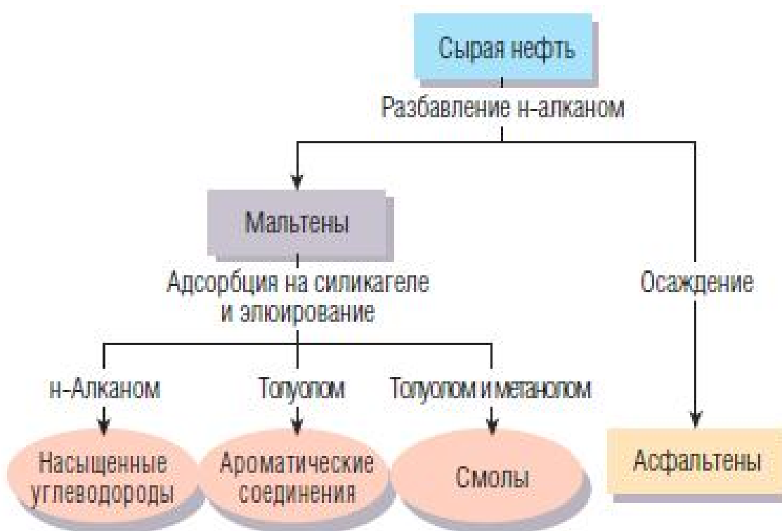
Рис. 7. Схема разделения нефти на фракции растворителями и сорбентом (SARA) [68]
