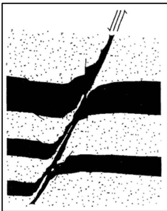
Рис. 4.3. Внедрение глин в плоскость нарушения [26]
