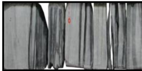
Рис. 4.7. Присбросовая вертикальная раздробленность и трещиноватость пород [15, 159]; скв.168Р Ватьеганского месторождения
