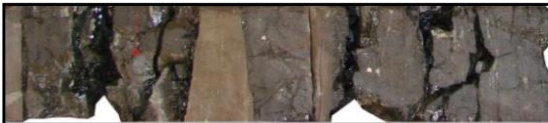
Рис. 4.6. Интенсивная раздробленность и трещиноватость пород, прилегающих к сбросу [15, 159]; скв.191 Ватьеганского месторождения; слой 7; пласт ЮВ 1 ; интервал 2886,33 – 2886,77 м; аргиллиты, алевролиты с фрагментами зеркал скольжения
