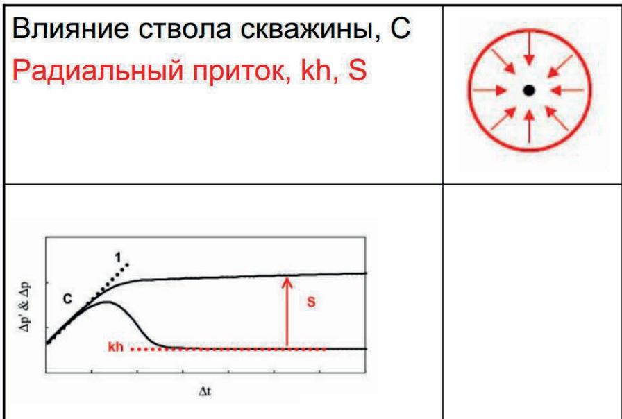
Рис. П1. Влияние ствола скважины и скин-фактор C – емкость ствола скважины, kh – проводимость пласта, S – скин-фактор
