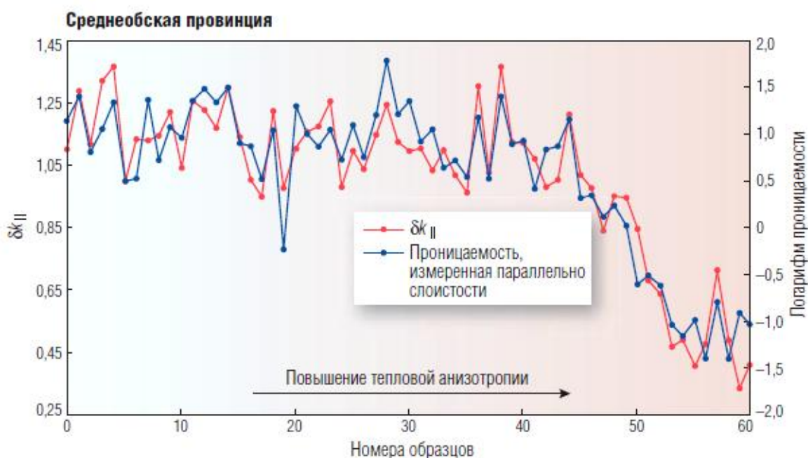
Рис. 4.9 Корреляция с проницаемостью величины тепловой анизотропии и степени её изменения в направлении слоистости при смене состояния образца с сухого на водонасыщенное ( \delta k_{||} ) [75]
