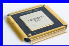
ПЕРВЫЙ 64-РАЗРЯДНЫЙ RISC-ПРОЦЕССОР, РАЗРАБОТАННЫЙ И ИЗГОТОВЛЕННЫЙ В РОССИИ КМОП 0,35 мкм; 3,4 млн. ТРАНЗИСТОРОВ 2007 год
