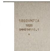
Система на кристалле с 128-разрядным RISC-микропроцессором архитектуры КОМДИВ с каналами ускоренного ввода-вывода и специализированным сопроцессором. Предназначена для построения систем обработки сигналов.
