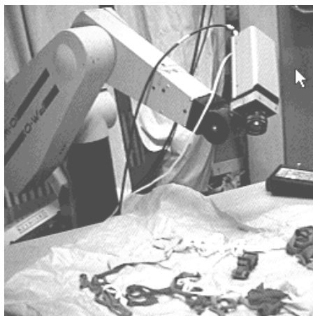
Рис.4. Общий вид исследовательского стенда с растровым визуальным сенсором, закрепленным на конце антропоморфного манипулятора.
