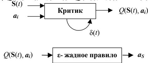
Рис. 1. Схема управления агента на основе Q-критика. Пояснения в тексте.
