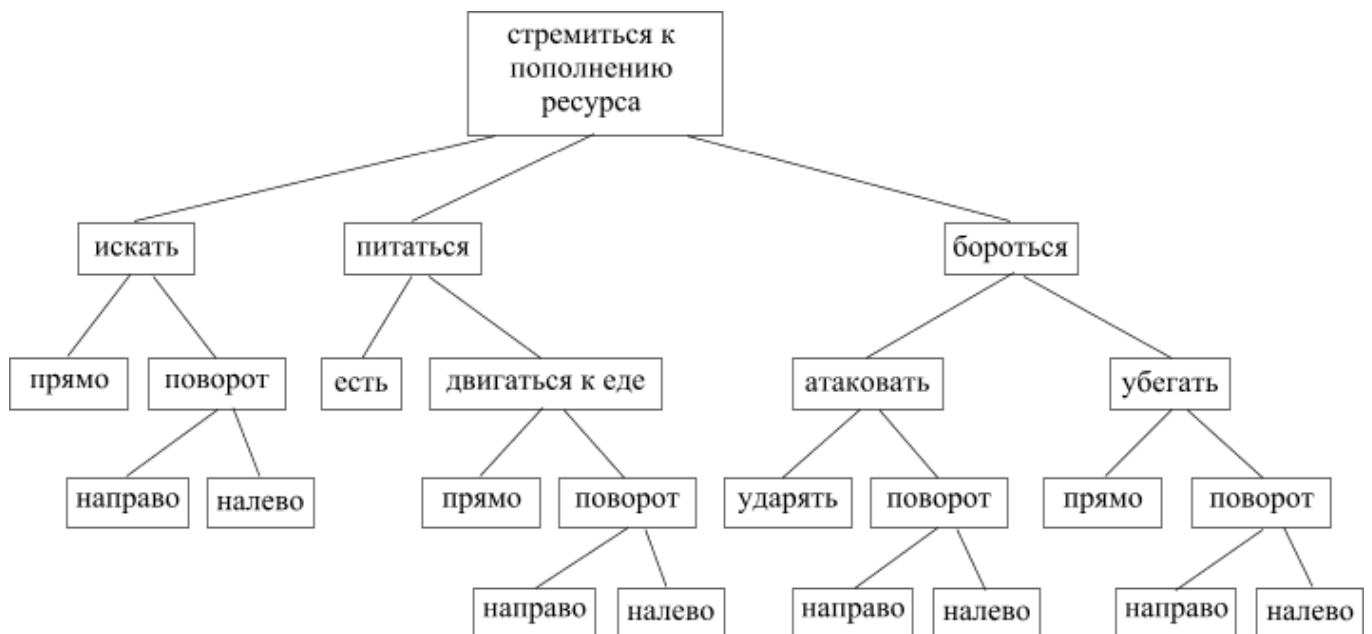
Рис. 2. Архитектура системы управления аниматором. Каждый блок представляет собой функциональную систему, реализованную на основе конструкции адаптивного критика и предназначенную для выбора одного из возможных действий.
