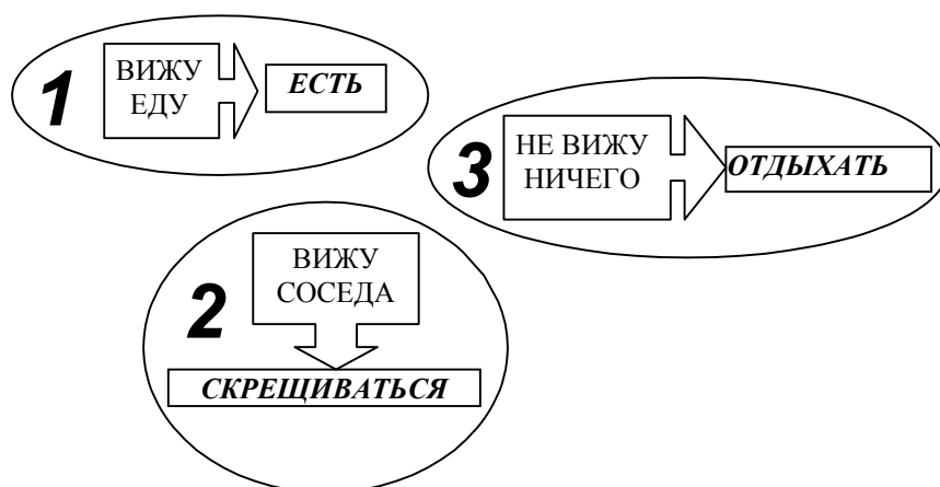
Рис. 11. Схема управления агента без мотиваций. Поведение агента состоит из одних только простых безусловных рефлексов, при котором выбор действия напрямую определяется текущим состоянием окружающей среды.
