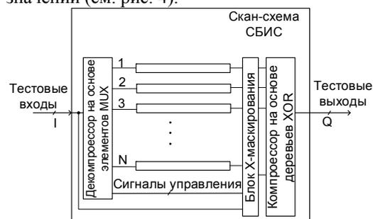
Рис. 4. Структура скан-схемы СБИС с X-компрессией и X-маскированием
