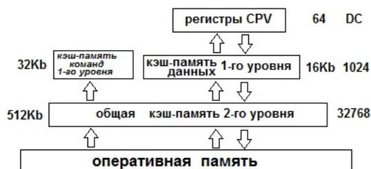
Рис. 1. Иерархическая структура памяти
