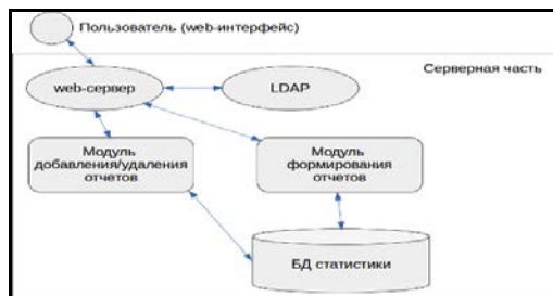
Рисунок 3. Структура программного средства «iscStatistics»
