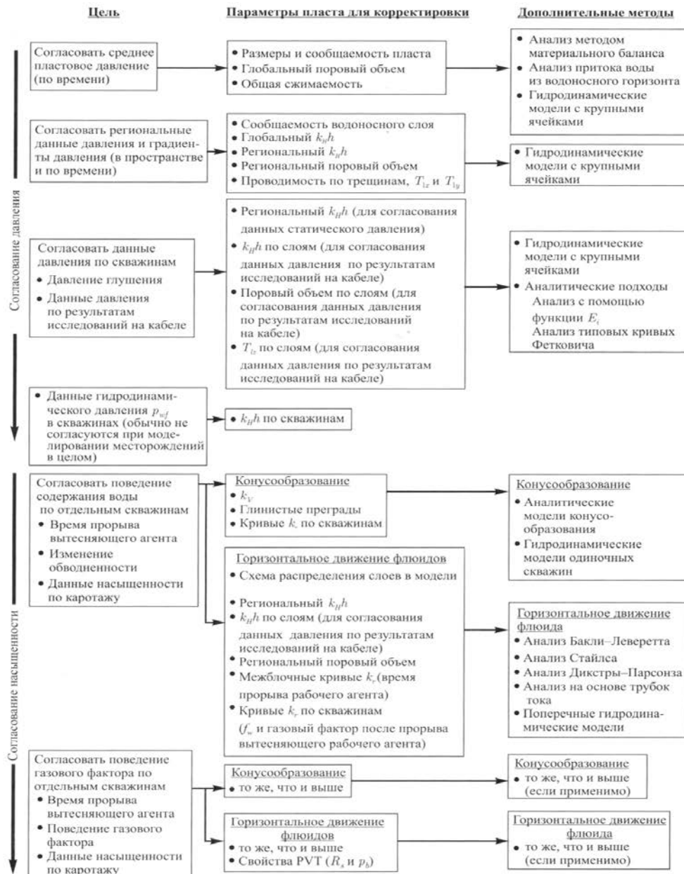
Рис. 3. Алгоритм ручной адаптации модели [8]
