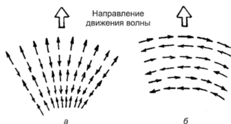
Рисунок 2. Схема смещения частиц среды при распространении продольных (а) и поперечных (б) волн.
