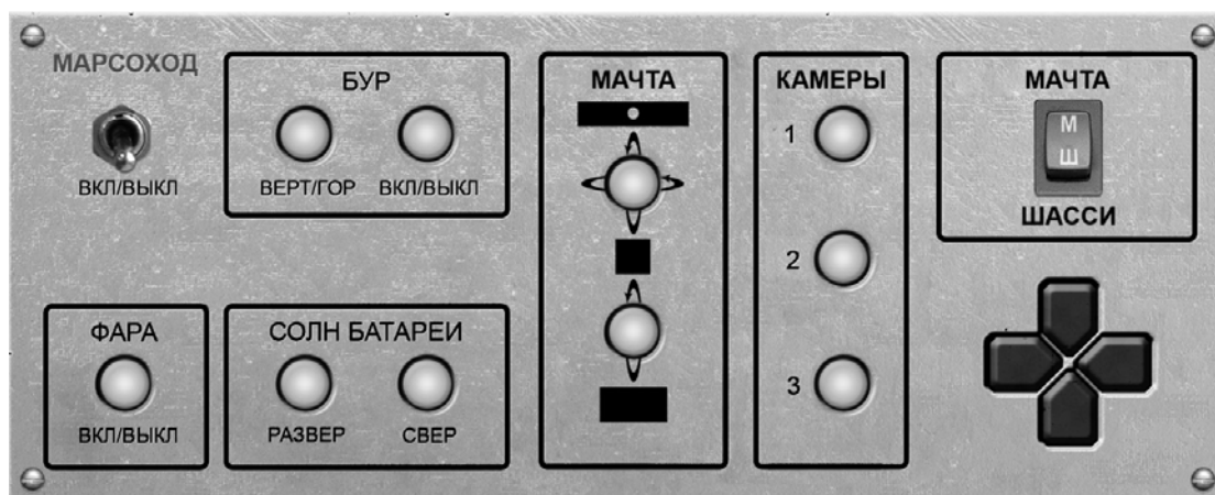
Рис. 3. Виртуальный пульт управления моделью марсохода
