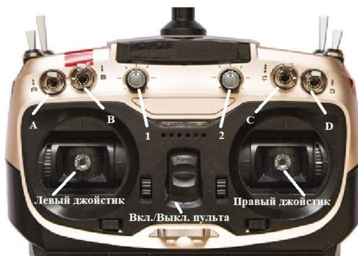
Рис. 2. Виртуальный пульт управления квадрокоптером
