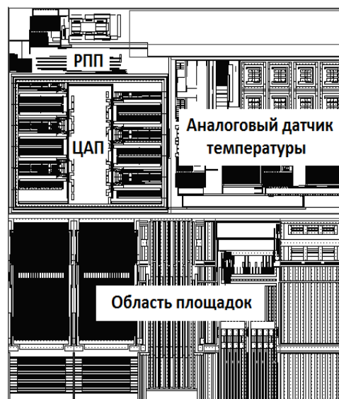
Рис. 6. Общий вид топологии СФ-блока.
