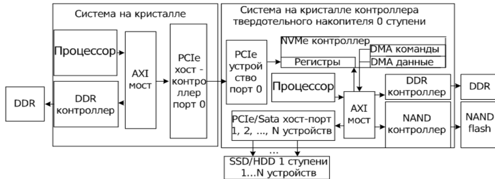
Рис. 3. Блок-схема представления структуры NVMe контроллера с дополнительным устройством, модернизированный 2-х ступенчатый контроллер
