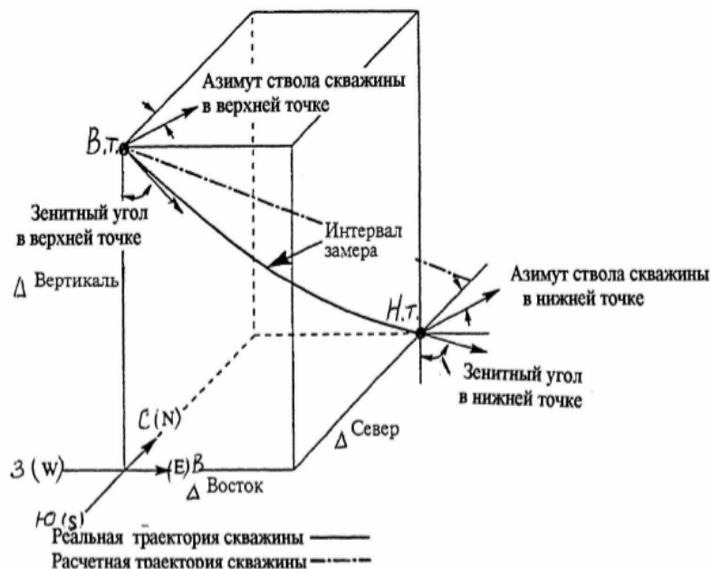
Рис. 2. Схема обработки инклинометрии тангенциальным методом [1]
