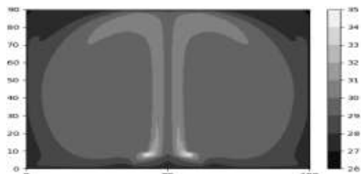
Рис.6б. Температурное поле воздуха в момент времени t=2,00 сек с охлаждением.
