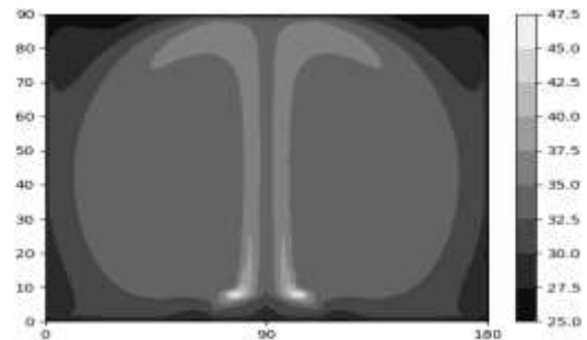
Рис. 6а. Температурное поле воздуха в момент времени t=1,00 сек с охлаждением со скоростью обдува V=3 м/с.
