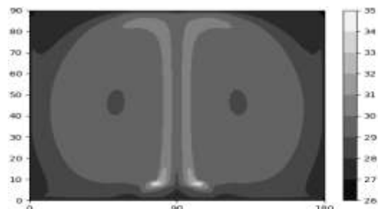
Рис. 3б. Температурное поле воздуха в момент времени t=0,50 \text{ сек} с охлаждением.
