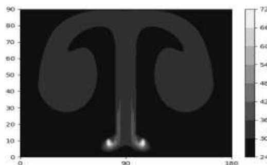
Рис.2а. Температурное поле воздуха в момент времени t = 0,05 сек с охлаждением со скоростью обдува V = 1 м/с.
