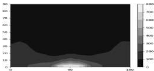
Рис.6б. Температурное поле воздуха в момент времени t=1,50 сек. при неадиабатическом условии.
