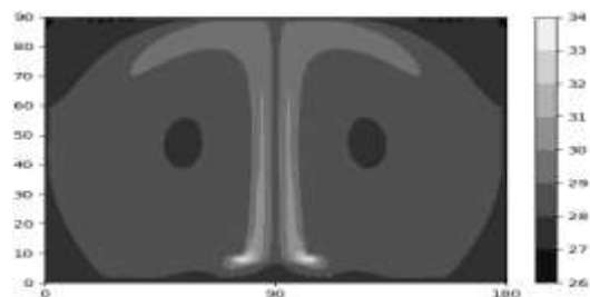
Рис. 2б. Температурное поле воздуха в момент времени t=0,20 \text{ сек} с охлаждением.
