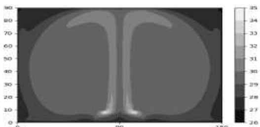
Рис.4б. Температурное поле воздуха в момент времени t=1,00 сек с охлаждением.
