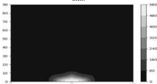
Рис.3б. Температурное поле воздуха в момент времени t=0,20 сек. при адиабатическом условии.
