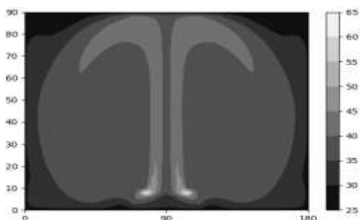
Рис.7а-7б. Температурное поле воздуха и поле вектор скоростей воздуха в момент времени t=1,00 сек с охлаждением со скоростью обдува V=5 м/с.
