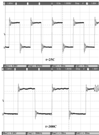
Рис. 2. Результаты измерений частоты генерации кольцевого генератора на осциллографе
