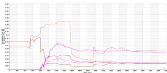
Рис. 18. Изменение доли добываемых УВ компонентов во времени по варианту 4, включая отбор C5-C7 (коричневая кривая), отбор C8-C11 (коричневая кривая - пунктир), отбор синтетической нефти из матрицы (красная кривая), для варианта 11 - отбор синтетической нефти из матрицы (сплошная малиновая кривая) и синтетической нефти из дренируемых интервалов (пунктир, малиновая кривая)
