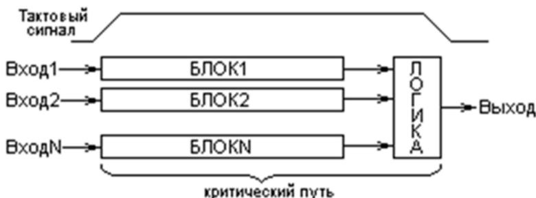
Рис.5.12. Структурная схема полутактового конвейера
