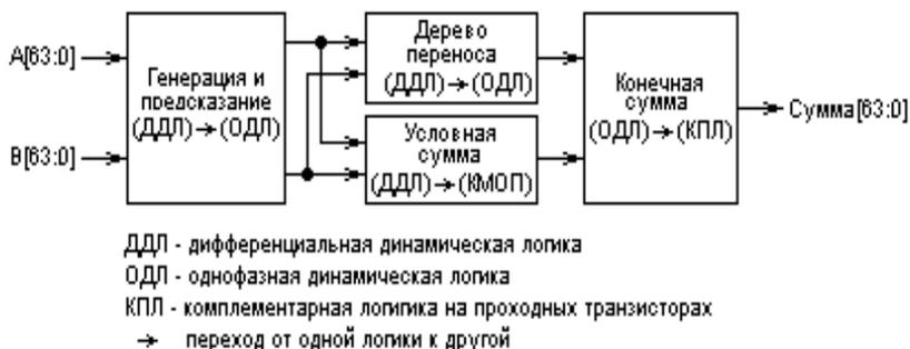
Рис.5.11. Структурная схема быстродействующего сумматора
